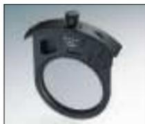
Diese sind zur Verwendung mit Teleobjektiven bestimmt, die über eine Filterschublade verfügen. Sie verringern Reflexe auf nichtmetallischen Flächen wie Glas oder Wasser. Die Filter können im Strahlengang des Objektivs von außen gedreht werden und beeinträchtigen weder die automatische Scharfeinstellung noch die Belichtungsmessung.
