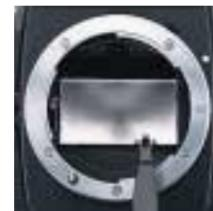
Bei F100, F90X, FM3A, FM2, Baureihe D1 Objektiv abnehmen und Scheibe wechseln.
