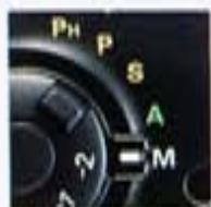
**Die Manuelle Belichtung.** Sie wählen mit dem Einstellrad die Verschußzeit und am Objektiv die Blende. Jede Abweichung vom gemessenen Wert (ob Matrix-, Mittenbetonte- oder Spotmessung) wird in der Flüssigkristallanzeige des Suchers in 1/3 EV-Stufen angegeben. Die Anzeige informiert auch über die eingestellte Verschußzeit; der eingestellte Blendenwert wird im ADR (Automatic Direct Readout-Blendendirektablesung) Fenster sichtbar.
