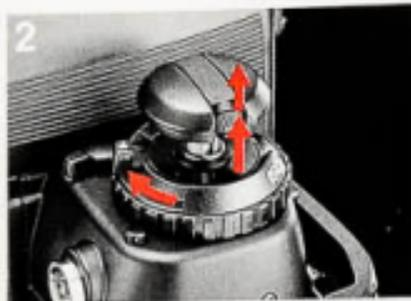
2 Kamerarückwand-Entriegelung betätigen und zugleich Rückspulrad anheben, bis die Kamerarückwand aufspringt.
