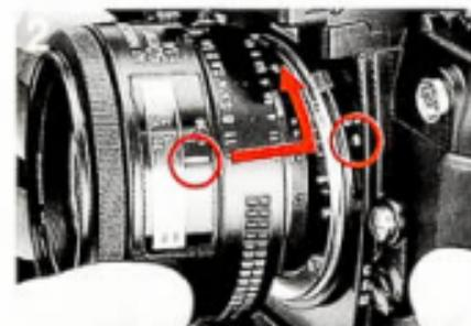
Objektiv im Gegenuhrzeigersinn drehen, bis es sicher einrastet.
