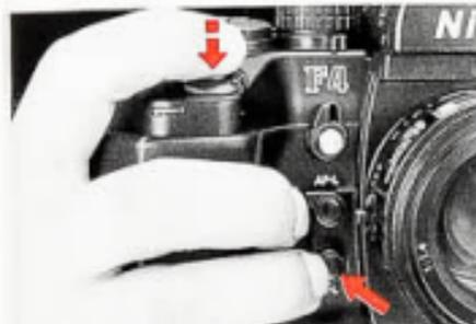
4. Während der Auslöser leicht niedergedrückt wird, AE-L-Taste betätigen und gedrückt halten.
