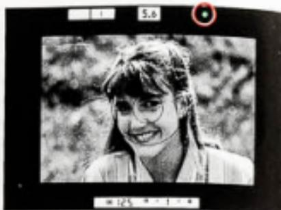
Bei Autofokusbetrieb das Fokussiermaßfeld auf das Hauptobjekt richten, den Auslöser antippen und kontrollieren, ob im Sucher die "In-Fokus"-LED (●) aufleuchtet. Bei Aufnahmen mit automatischer Fokussierung bleibt die "In-Fokus"-LED abgeschaltet (siehe Seite 37).
