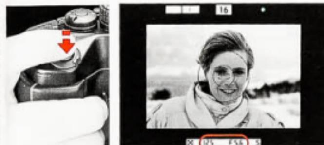
3. Auslöser leicht niederdrücken, bis Belichtungsanzeigen erscheinen. Die Blendeneinstellung erfolgt stufenlos innerhalb des Objektiv-Blendenbereichs; angezeigt wird sie in 1/2-EV-Stufen.
