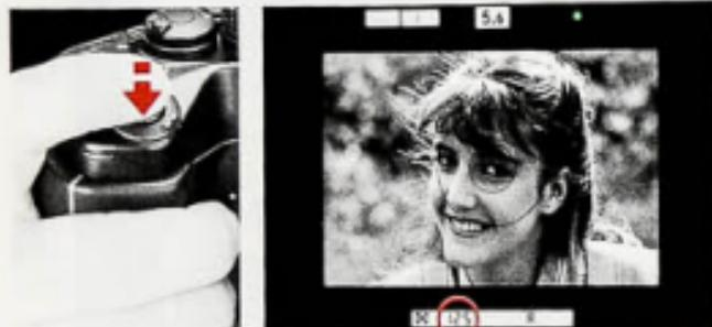
2. Auslöser leicht niederdrücken, bis die Belichtungsanzeigen erscheinen.
