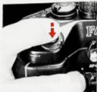
Bei Einstellung DX darf nur DX-codierter Film verwendet werden. Bei Verwendung eines nicht DX-codierten Films oder eines Films mit defekter DX-Codierung – oder wenn gar kein Film eingelegt wurde – blinkt die rote Warnanzeige, sobald Sie den Auslöser leicht niederdrücken; gleichzeitig wird der Auslöser gesperrt.
