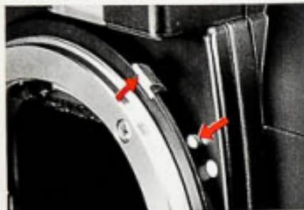
Bevor Sie ein Nicht-AI-Objektiv an die F4 ansetzen, muß die Entriegelung für die Belichtungsmesserkupplung betätigt und der Hebel für Belichtungsmesserkupplung in die obere Position geschoben werden. Danach Belichtungsmessung mit Arbeitsblende vornehmen (siehe Seite 59).
