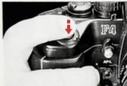
3. Durch leichtes Drücken des Auslösers Autofokus aktivieren.
