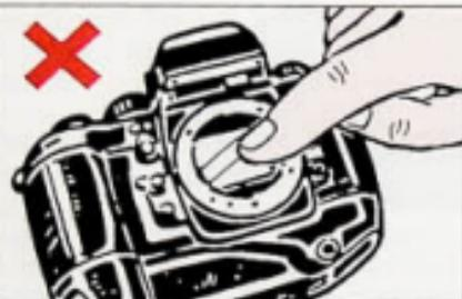
1. Umlenkspiegel und Einstellscheibe nicht berühren. Staub mit einem Blasepinsel entfernen.
