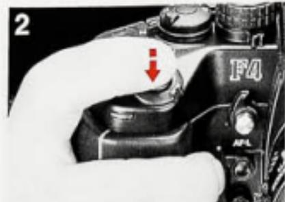
Dann Auslöser antippen, so daß im Sucher die Flüssigkristallanzeige (LCD) aktiviert wird. Bleibt die Anzeige während ca. 16 Sek. sichtbar, nachdem Sie den Finger vom Auslöser genommen haben, so bedeutet dies ausreichende Batteriespannung.
