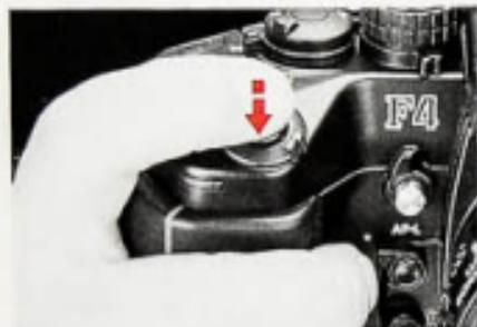
3. Auslöser leicht niederdrücken, um die automatische Fokusschaltung zu aktivieren.
