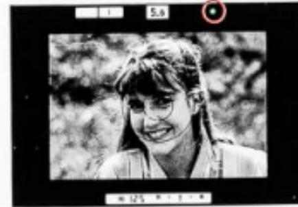
Bei manueller Scharfeinstellung (M) den Fokussiering des Objektivs drehen, bis das Sucherbild scharf ist und/oder die "In-Fokus"-Anzeige (●) des elektronischen Entfernungsmessers aufleuchtet.
