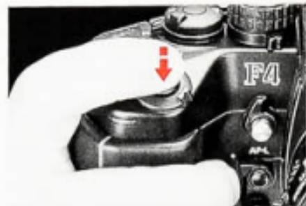
1. Rasten Sie die gewünschte Verschlusszeit am Verschlusszeitenwähler (4s bis 1/8000s) ein und wählen Sie mit dem Blendenring die Blende (die Blenden lassen sich kontinuierlich, auch in Zwischenwerten, anwählen).
